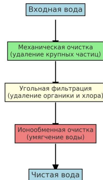
Рис. 1. Схема многоступенчатой фильтрации воды, включающая механическую, угольную и ионообменную очистку.
