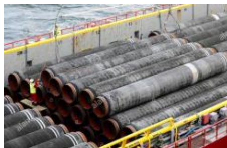
Şəkil 3. Üzəri betonla örtülmüş borular
